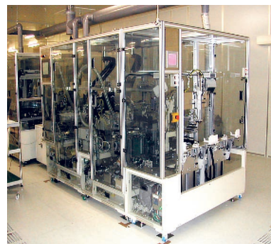
57インチOLP/PCDリペア自動装置
