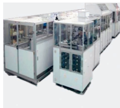
57インチOLP/PCDリペア自動装置
